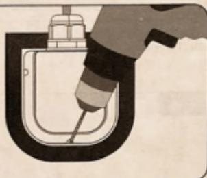
Placez et maintenez le support de câble assemblé à l'intérieur des marquages de bande. Percer trois (3) trous de 2mm
