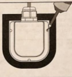
Fix support de câble sur le toit du véhicule avec trois (3) des vis M4 x 20 sur les trous de forage effectués
